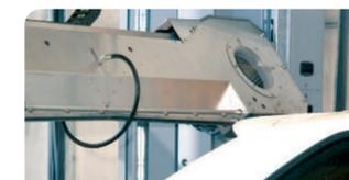
Convogliatore superiore in acciaio inox a seguire il profilo, orientabile su tre posizioni. 2 ventilatori superiori da 3 kW. 2 ventilatori laterali da 4 kW.
